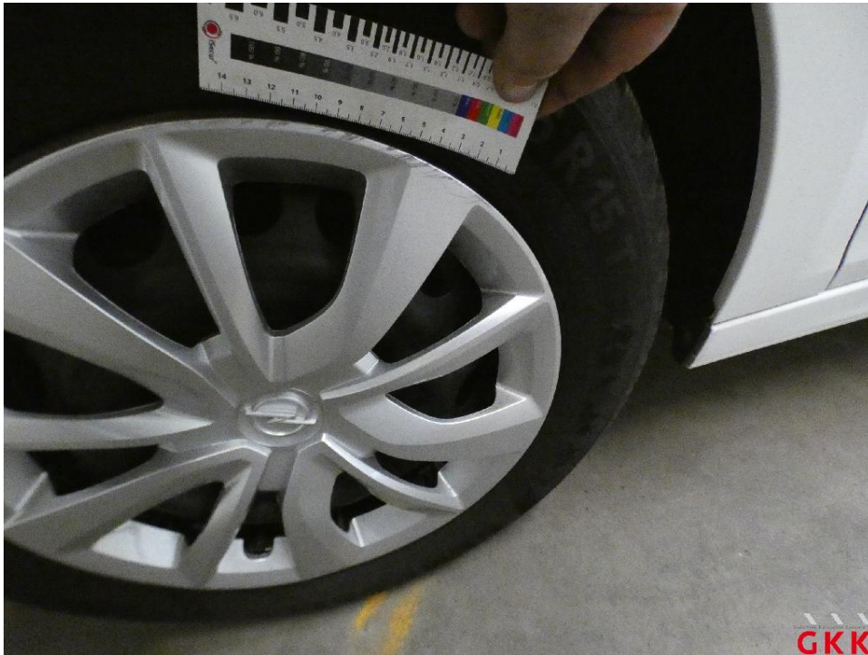
Bild 21 Radkappe(n), Satz, beschädigt, ersetzen
