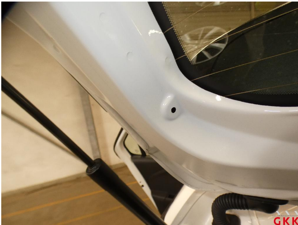
Bild 16 Halter Laderaumabdeckung links, fehlt, ersetzen
