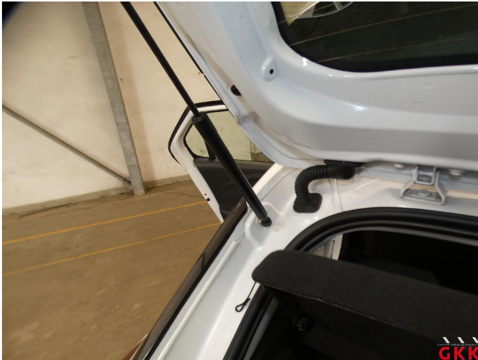
Bild 15 Halter Laderaumabdeckung links, fehlt, ersetzen
