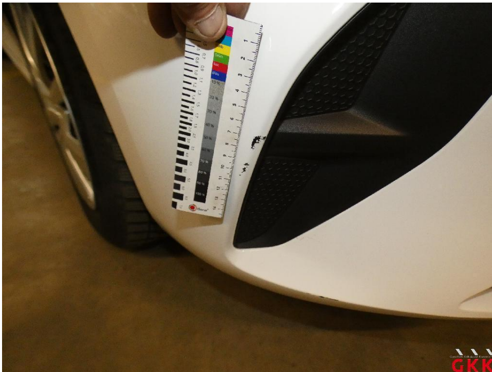
Bild 24 Stoßfänger vorne, Verkleidung -lackiert-, verkratzt, lackieren
