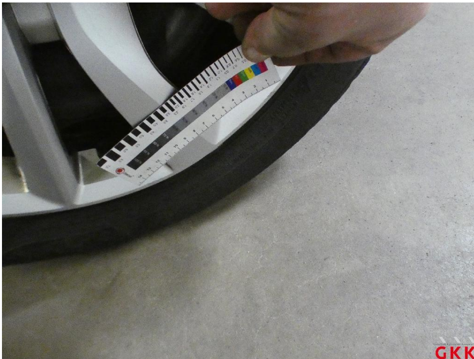
Bild 22 Radkappe(n), Satz, beschädigt, ersetzen
