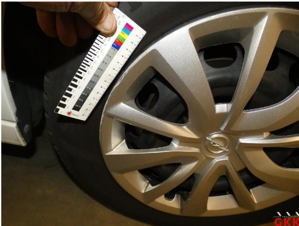
Bild 20 Radkappe(n), Satz, beschädigt, ersetzen
