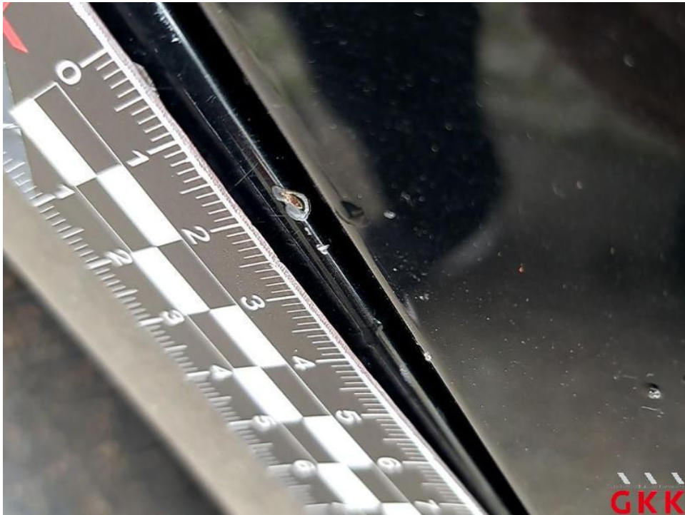
Bild 42. Seitenwand rechts, verkratzt, auslegen, schleifen, polieren
