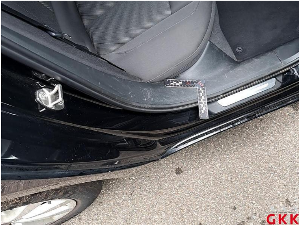
Bild 25. C- Säule rechts, Innenverkleidung -unterhalb-, verkratzt, ersetzen
