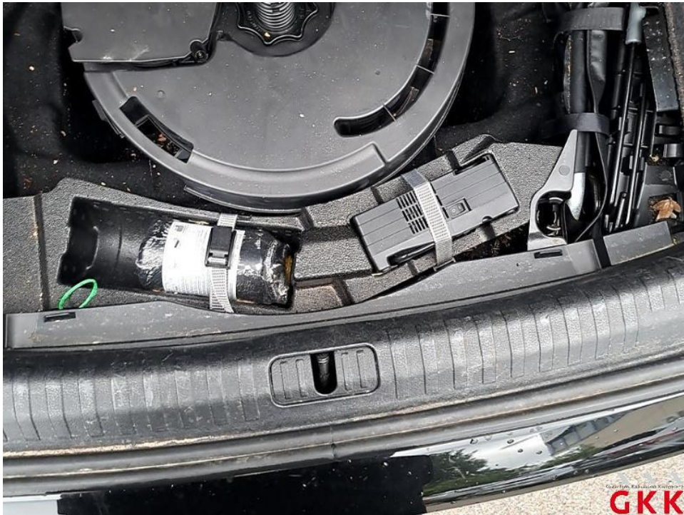
Bild 14. Reifenreparaturset, Füllflasche, MHD überschritten, ersetzen
