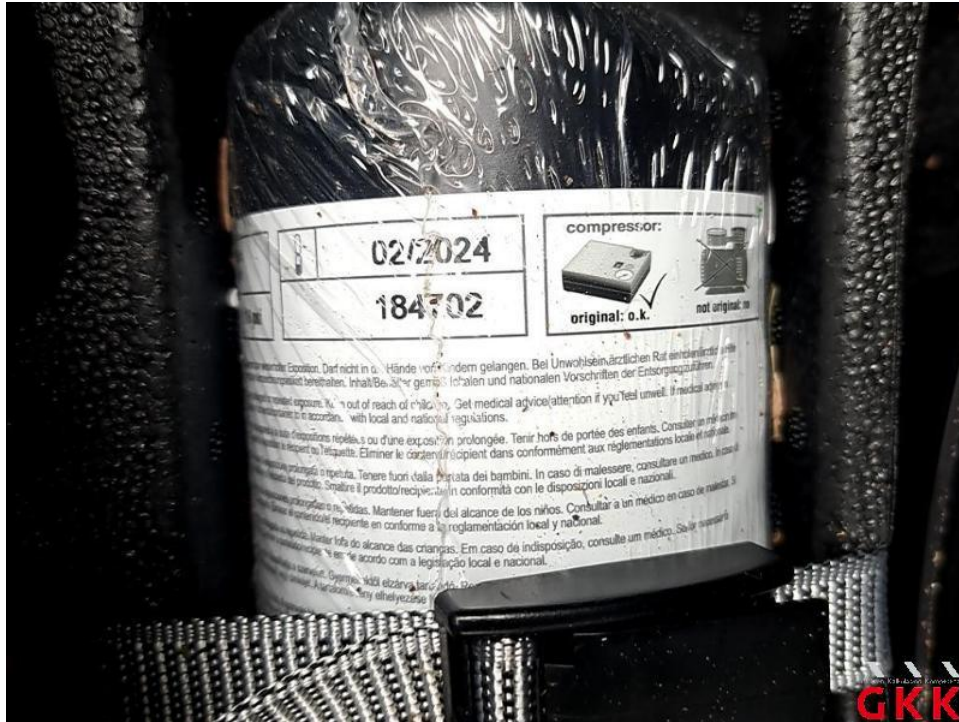
Bild 15. Reifenreparaturset, Füllflasche, MHD überschritten, ersetzen
