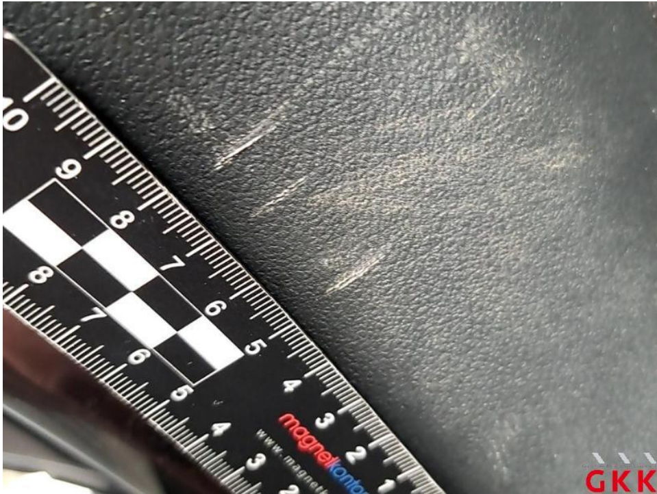
Bild 27. C- Säule rechts, Innenverkleidung -unterhalb-, verkratzt, ersetzen
