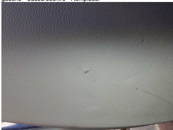
Dommage #6: Habillages/Protections: Habillage porte arrière gauche - Cassé/déchiré - Remplacer
