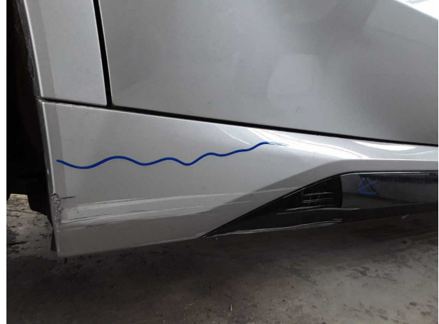
Beschädigung #4: Schweller rechts: Verkleidung - verkratzt / verschürft - erneuern
