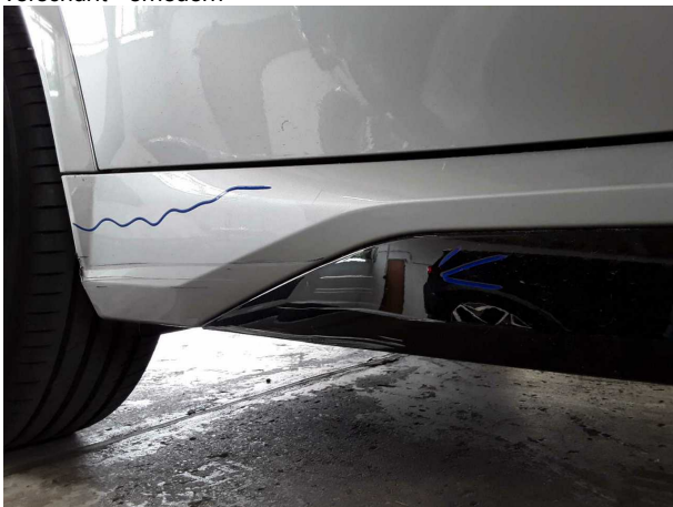
Beschädigung #4: Schweller rechts: Verkleidung - verkratzt / verschürft - erneuern
