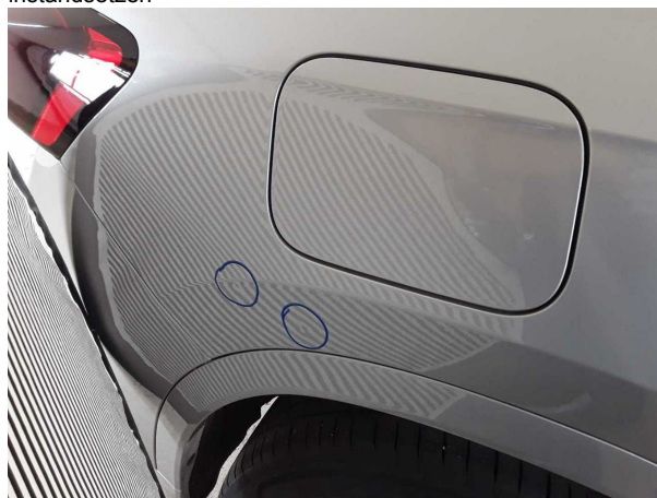
Beschädigung #2: Seitenwand rechts: Seitenwand - Delle(n) - sanft instandsetzen
