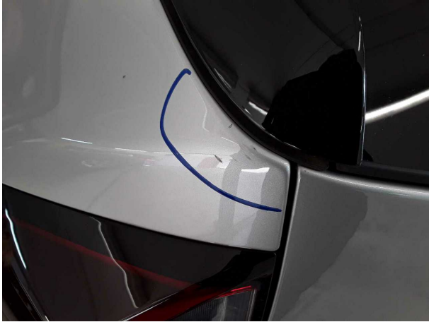
Beschädigung #6: Seitenwand links: Seitenwand - verkratzt / verschürft - lackieren
