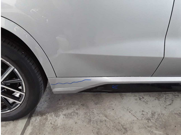
Beschädigung #4: Schweller rechts: Verkleidung - verkratzt / verschürft - erneuern
