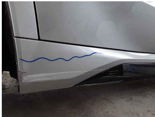
Domage #4: Seuil droit: Habillage - Eraflé - Remplacer
