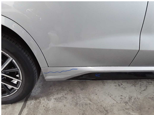
Domage #4: Seuil droit: Habillage - Eraflé - Remplacer
