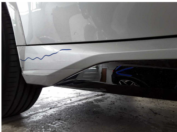
Domage #4: Seuil droit: Habillage - Eraflé - Remplacer
