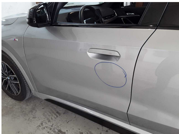
Domage #1: Porte AvG: Porte - bosse(s) - Bon travail de réparation
