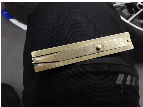
Beschädigung #4: 2.Radsatz: 2 Reifen - verschlissen - erneuern
