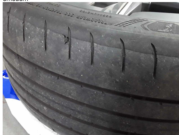
Beschädigung #4: 2.Radsatz: 2 Reifen - verschlissen - erneuern
