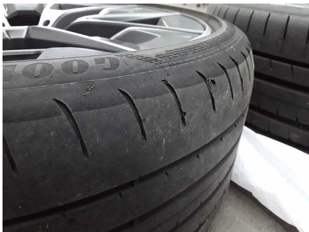
Beschädigung #4: 2.Radsatz: 2 Reifen - verschlissen - erneuern
