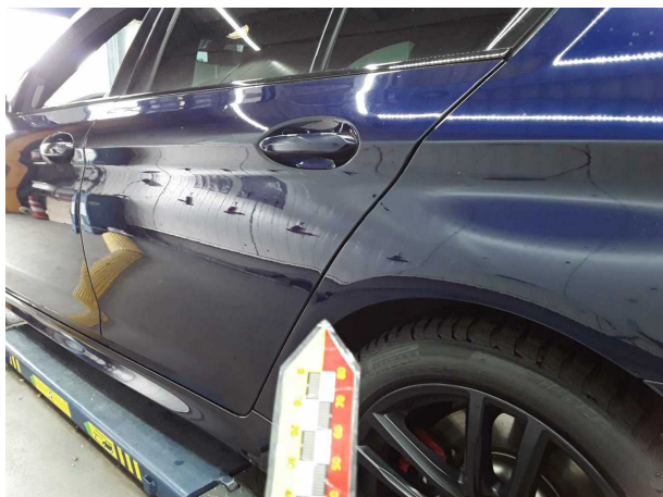
Beschädigung #1: Seitenwand links: Kniestück - Delle(n) - sanft instandsetzen
