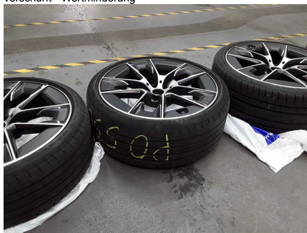
Beschädigung #4: 2.Radsatz: 2 Reifen - verschlissen - erneuern
