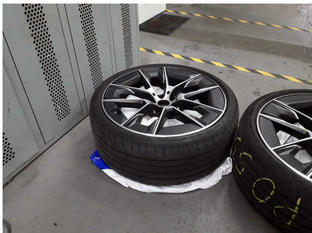
Beschädigung #4: 2.Radsatz: 2 Reifen - verschlissen - erneuern
