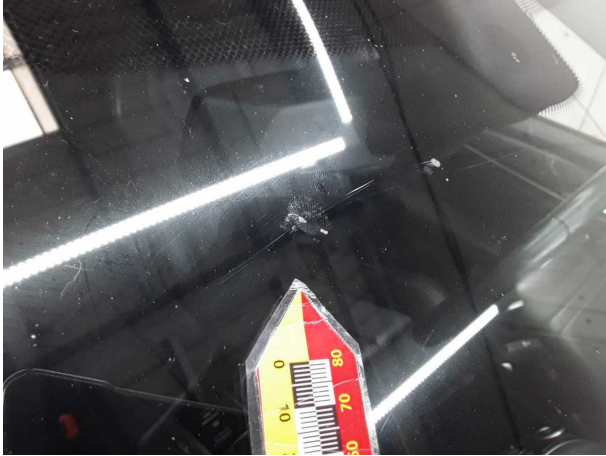
Beschädigung #5: Verglasung: Frontscheibe mit Spurhalteassistent - Steinschlag - erneuern
