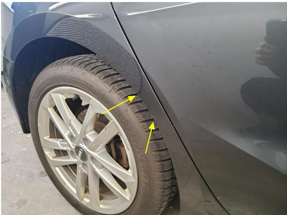
Bild 14 : Seitenteil hinten rechts Lackierung unterhalb, zerkratzt, lackieren mit Lackaufbau
