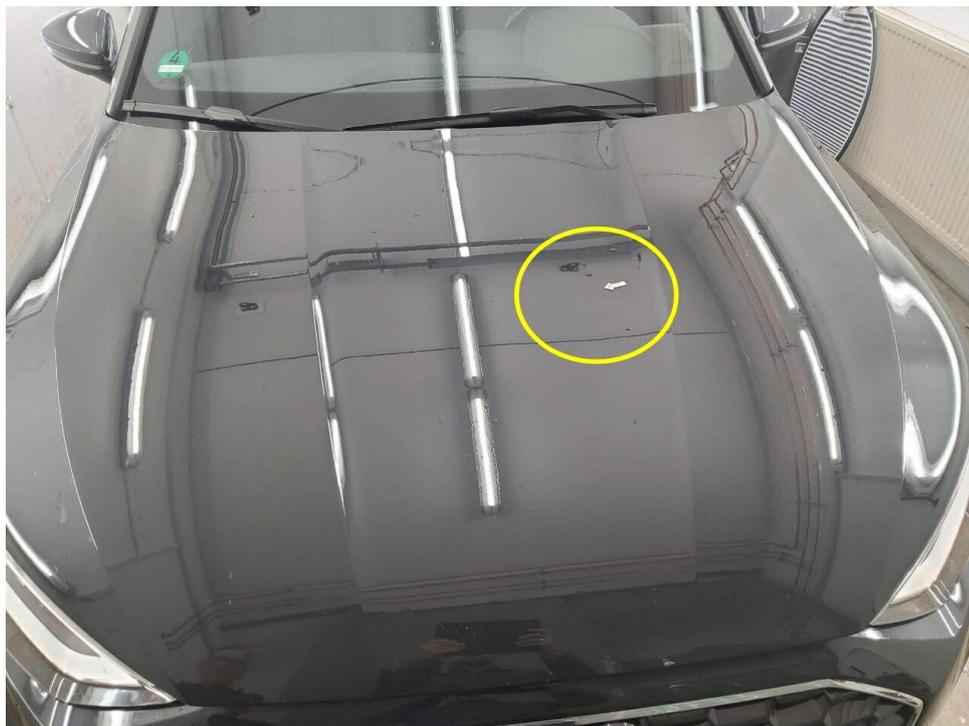
Bild 17 : Motorhaube Lackierung, zerkratzt, lackieren mit Lackaufbau
