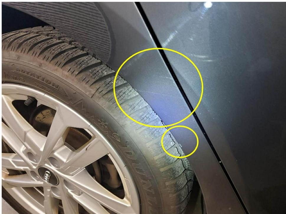
Bild 15 : Seitenteil hinten rechts Lackierung unterhalb, zerkratzt, lackieren mit Lackaufbau
