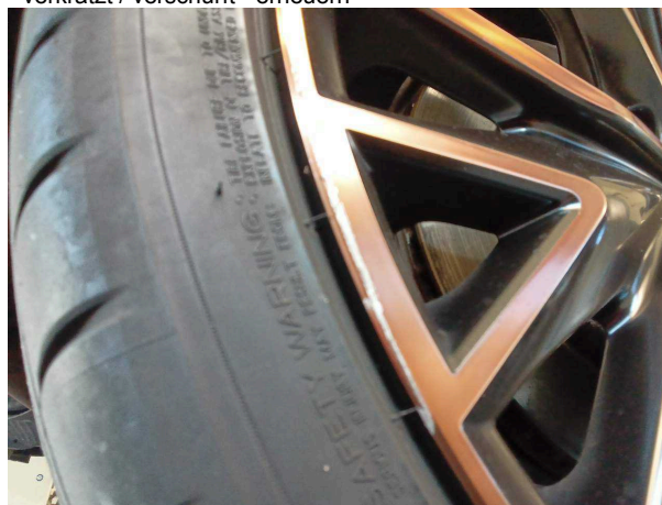
Beschädigung #4: Rad/Reifen: Leichtmetallfelge hinten rechts - verkratzt / verschürft - erneuern
