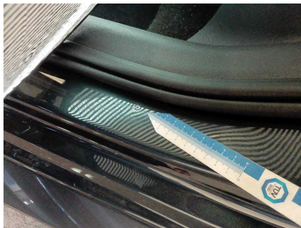
Beschädigung #1: Seitenwand links: Einstieg - Delle(n) - sanft instandsetzen
