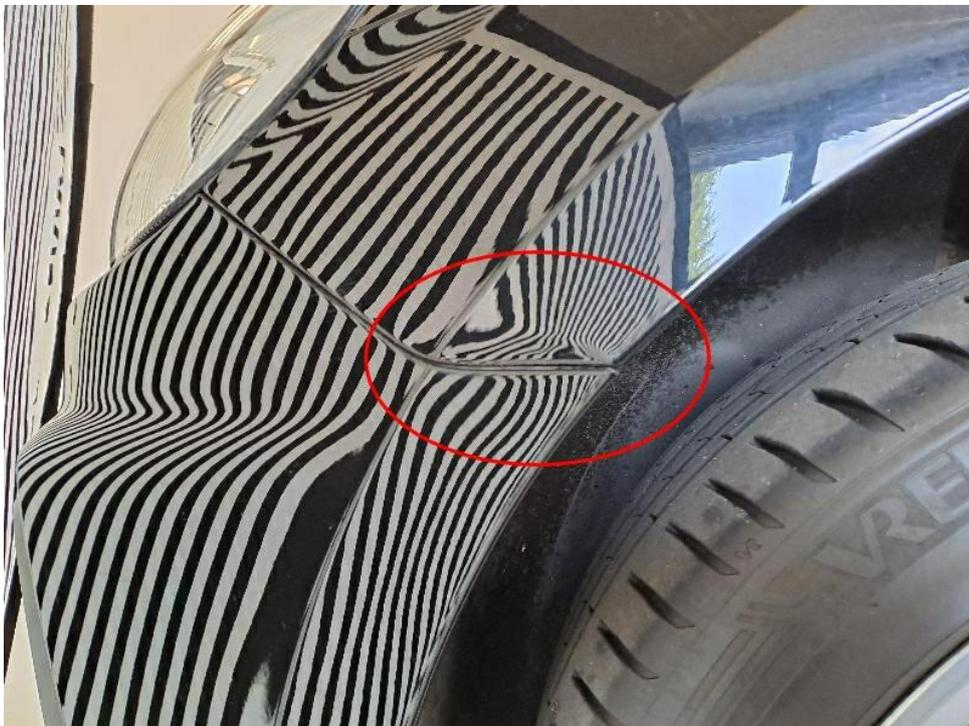
Bild 16 : Streifschaden vorne links: Stoßfänger + Kotflügel
