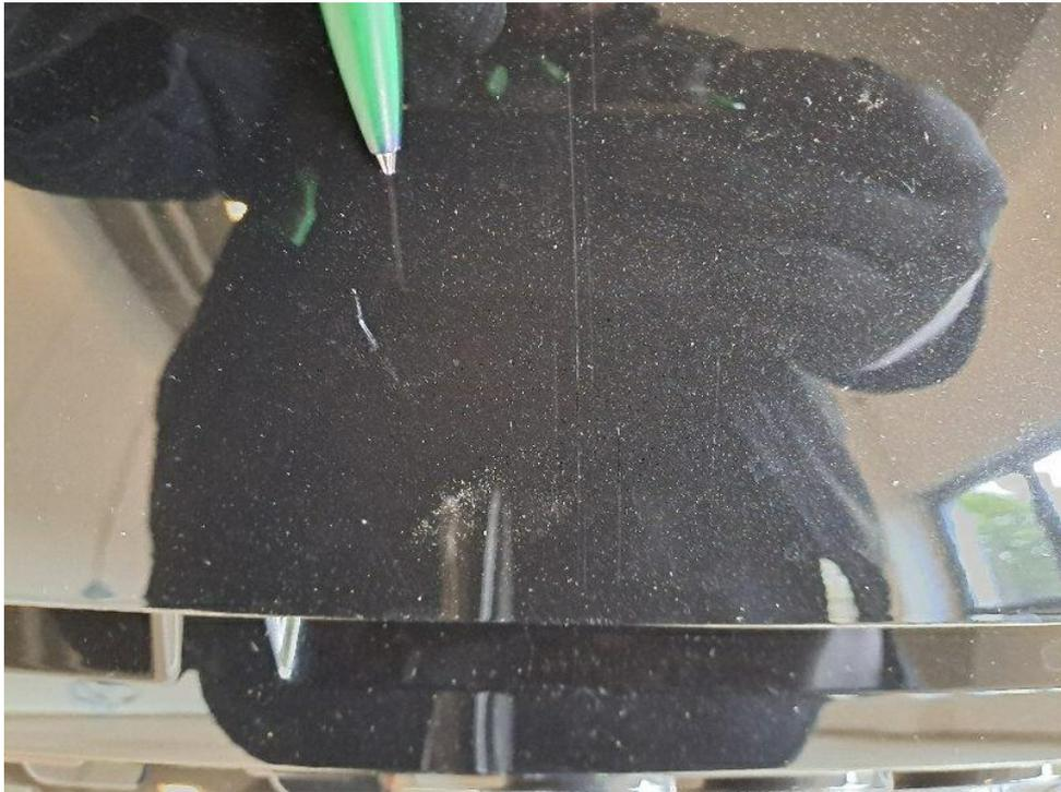
Bild 13 : Motorhaube Steinschlag
