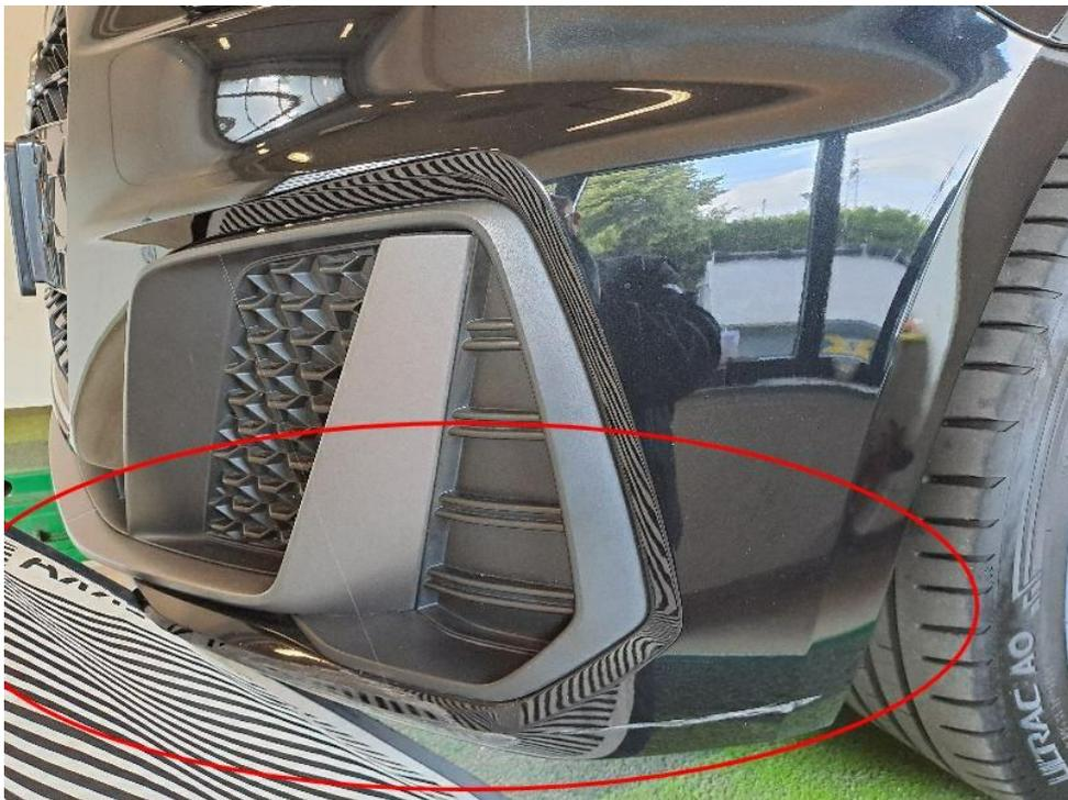
Bild 14 : Streifschaden vorne links: Stoßfänger + Kotflügel
