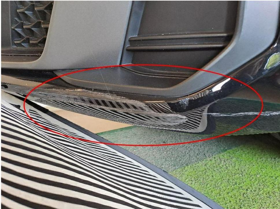
Bild 15 : Streifschaden vorne links: Stoßfänger + Kotflügel
