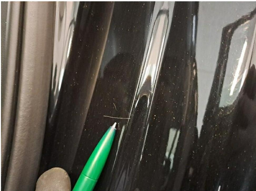
Bild 22 : Einstieg hinten links Kratzer
