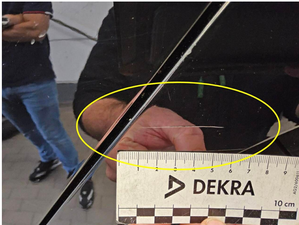
Bild 27 : Seitenteil hinten links Lackierung, verschrammt, smart repair
