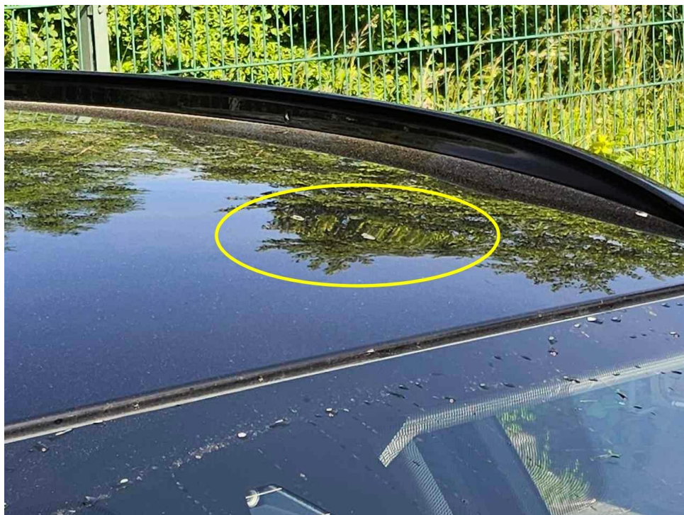
Bild 32 : Dach, eingedellt, drücken
