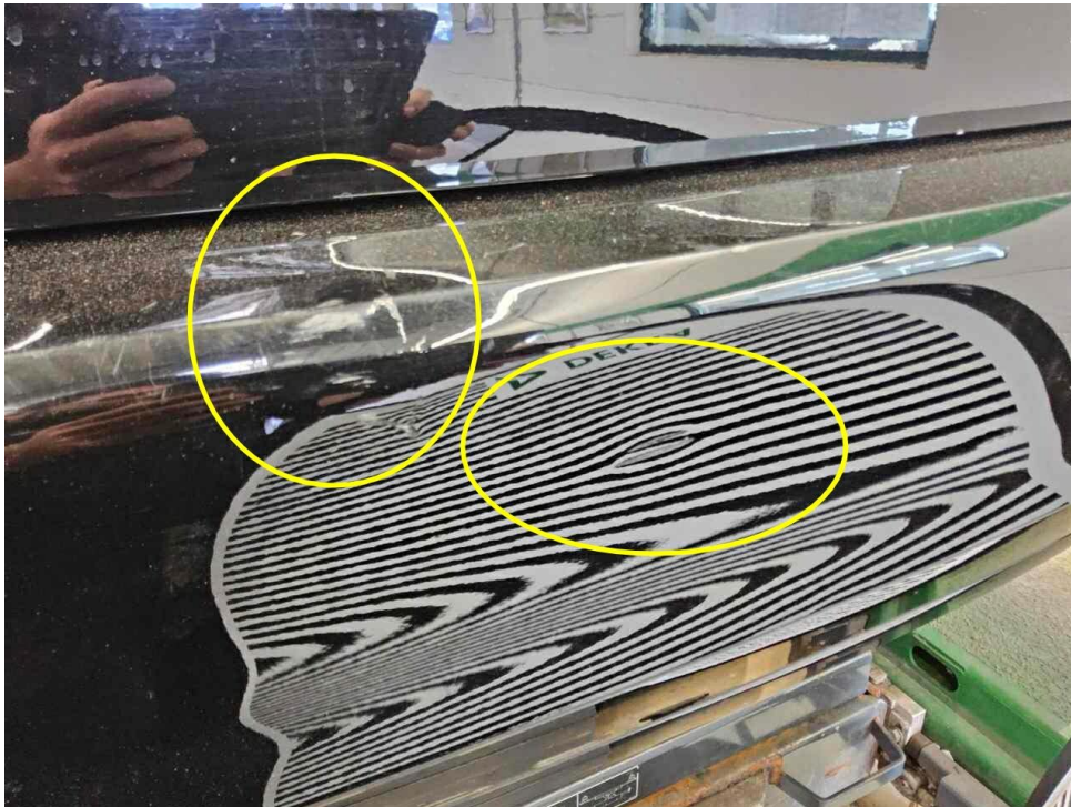
Bild 23 : Stoßfänger hinten mehrfach verformt
