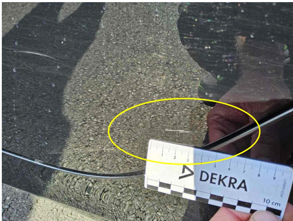
Bild 36 : Tür hinten links Lackierung, zerkratzt, lackieren mit Lackaufbau
