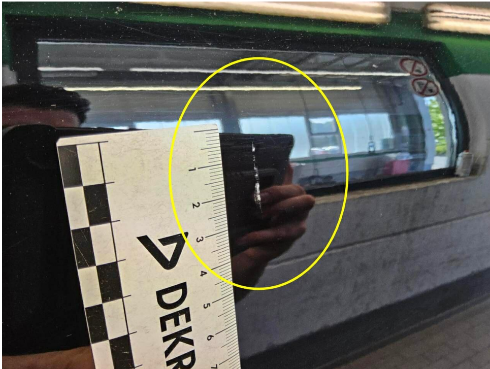
Bild 21 : Tür hinten rechts Lackierung, verschrammt, lackieren mit Lackaufbau
