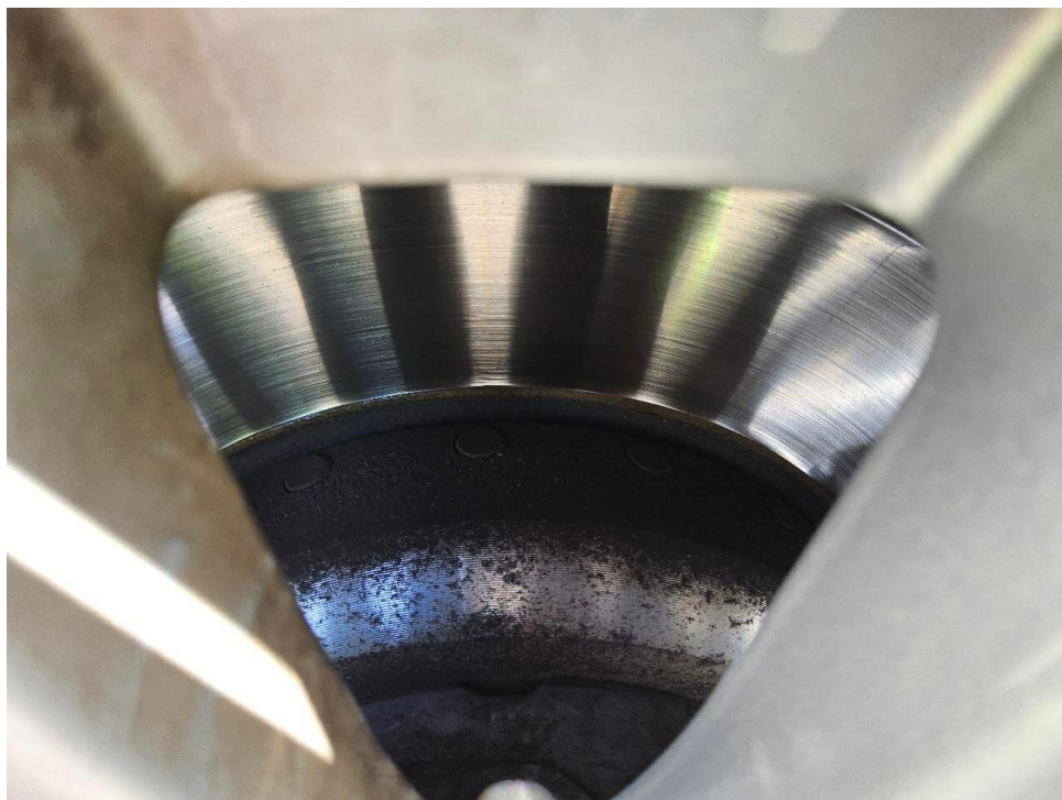
Bild 44 : Bremsscheiben der Vorderachse demnächst verschlissen, Gebrauchsspur
