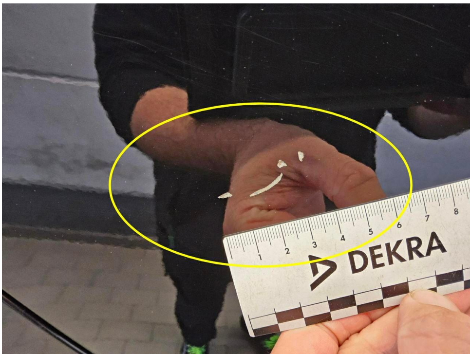
Bild 22 : Tür hinten rechts Lackierung, verschrammt, lackieren mit Lackaufbau
