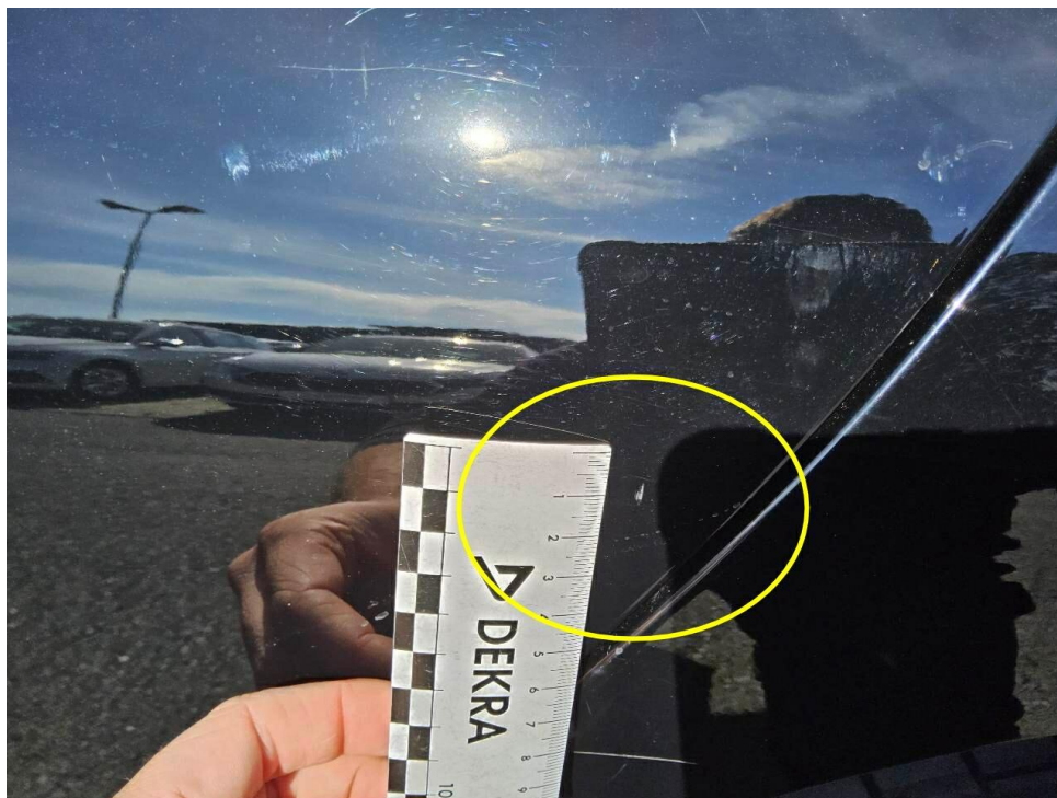
Bild 35 : Tür hinten links Lackierung, zerkratzt, lackieren mit Lackaufbau
