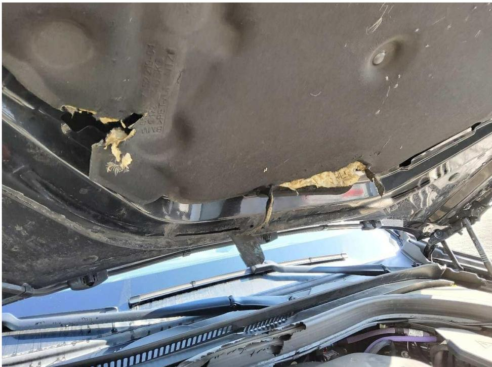
Bild 18 : Motorhaube: Dämm/Schllschutz beschädigt.
