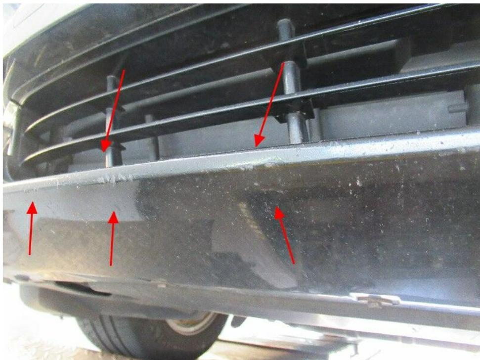
Bild 22 : Stoßfänger vorne Lackierung, zerkratzt, smart repair
