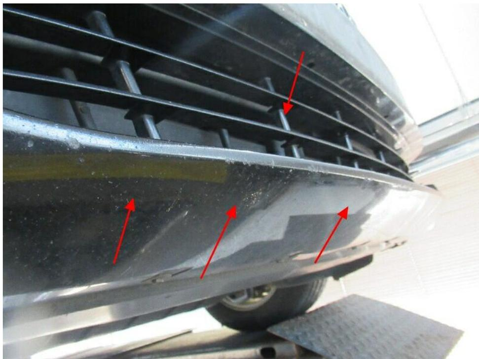
Bild 20 : Stoßfänger vorne Lackierung, zerkratzt, smart repair
