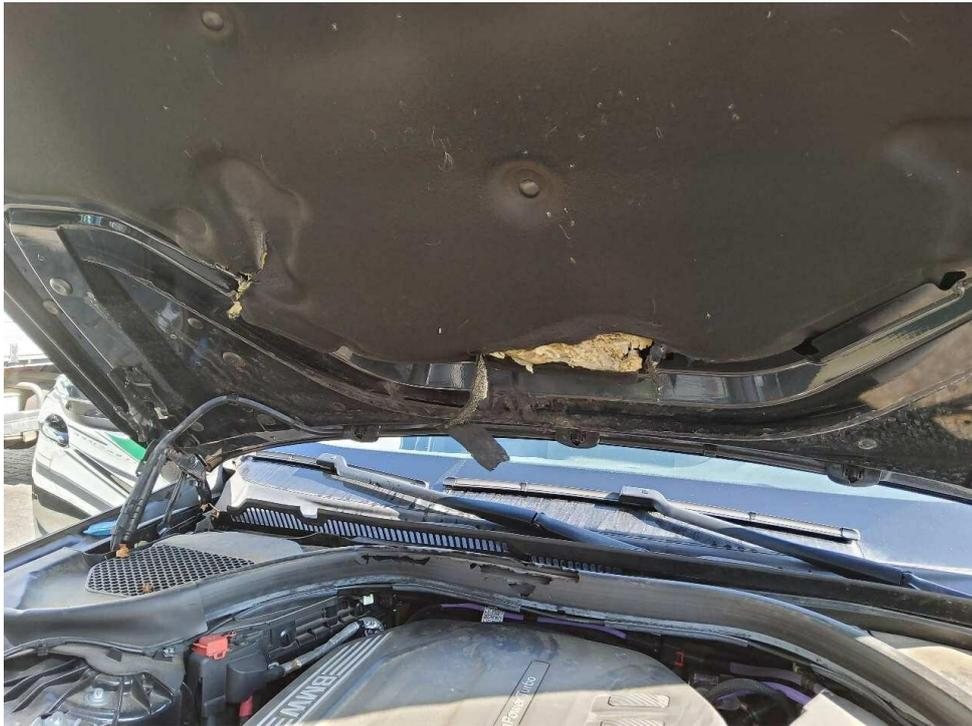
Bild 17 : Motorhaube: Dämm/Schllschutz beschädigt.
