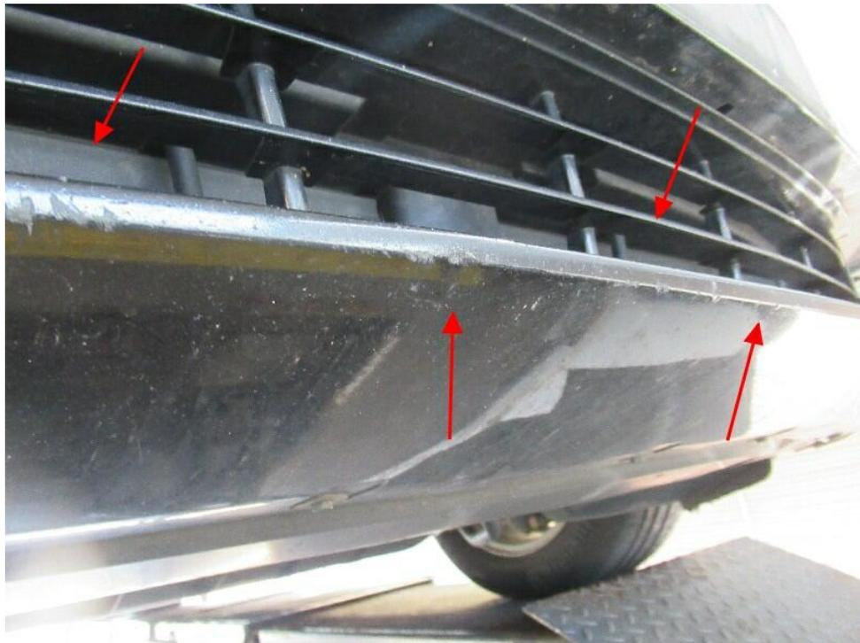
Bild 21 : Stoßfänger vorne Lackierung, zerkratzt, smart repair
