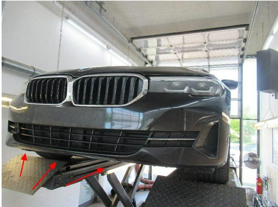
Bild 19 : Stoßfänger vorne Lackierung, zerkratzt, smart repair
