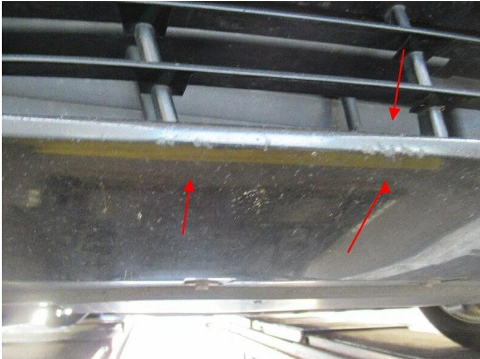
Bild 23 : Stoßfänger vorne Lackierung, zerkratzt, smart repair
