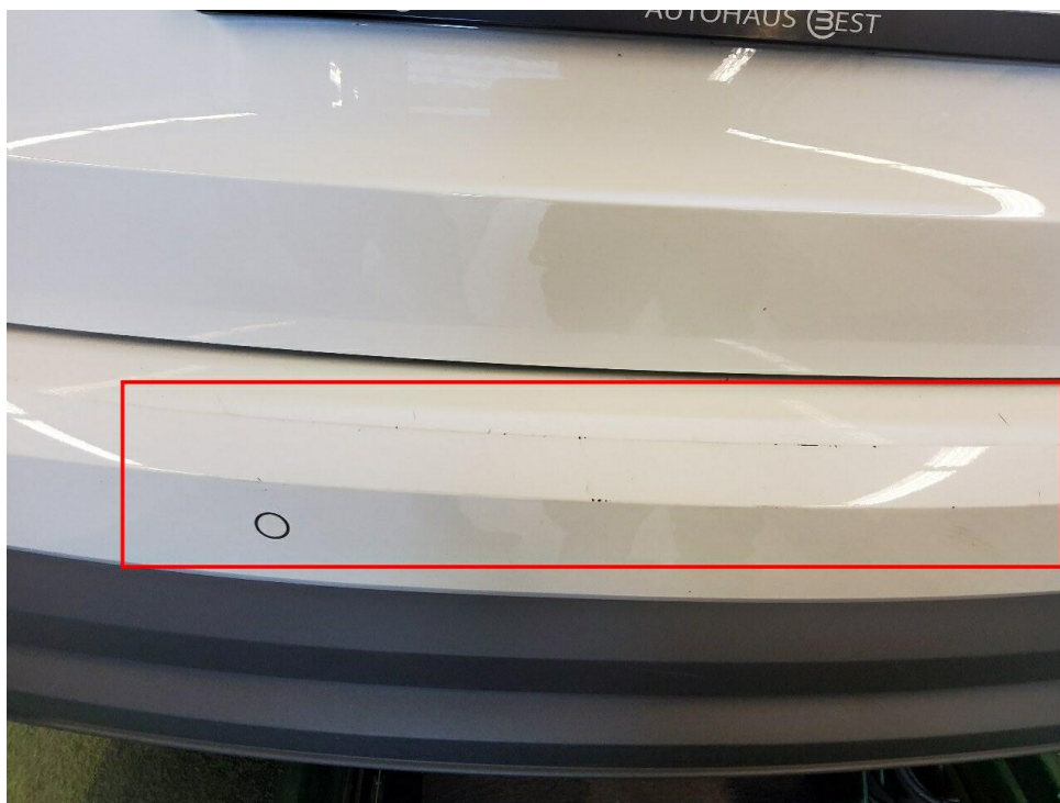
Bild 31 : Stoßfänger hinten Lackierung, zerkratzt, lackieren mit Lackaufbau
