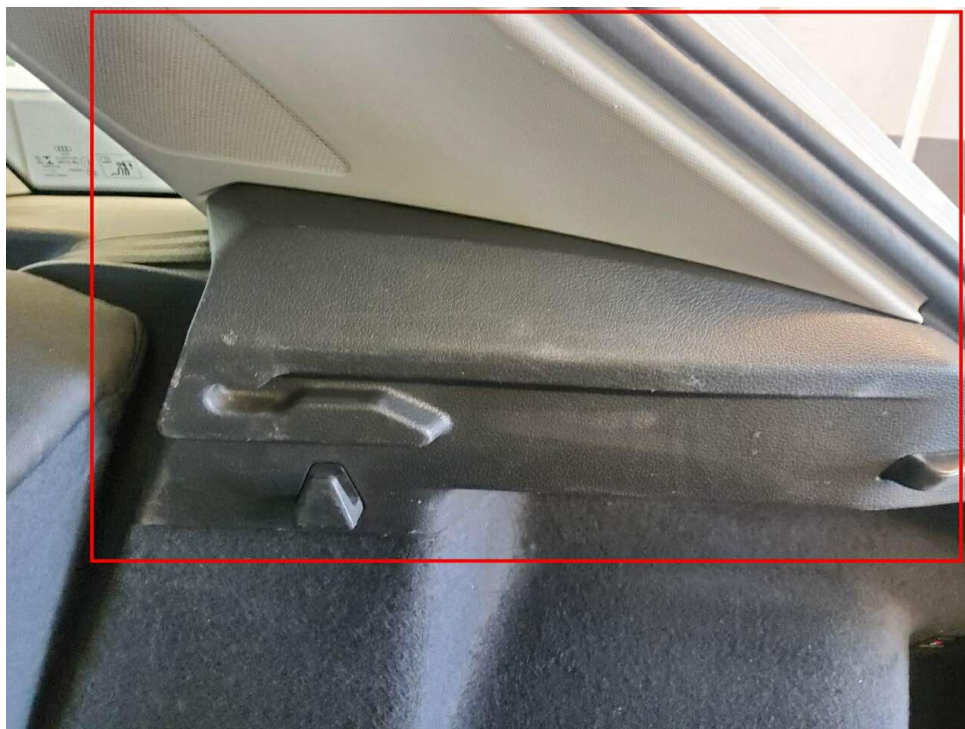
Bild 19 : Kofferraumverkleidungen, links und rechts, oben und unten, verschrammt
