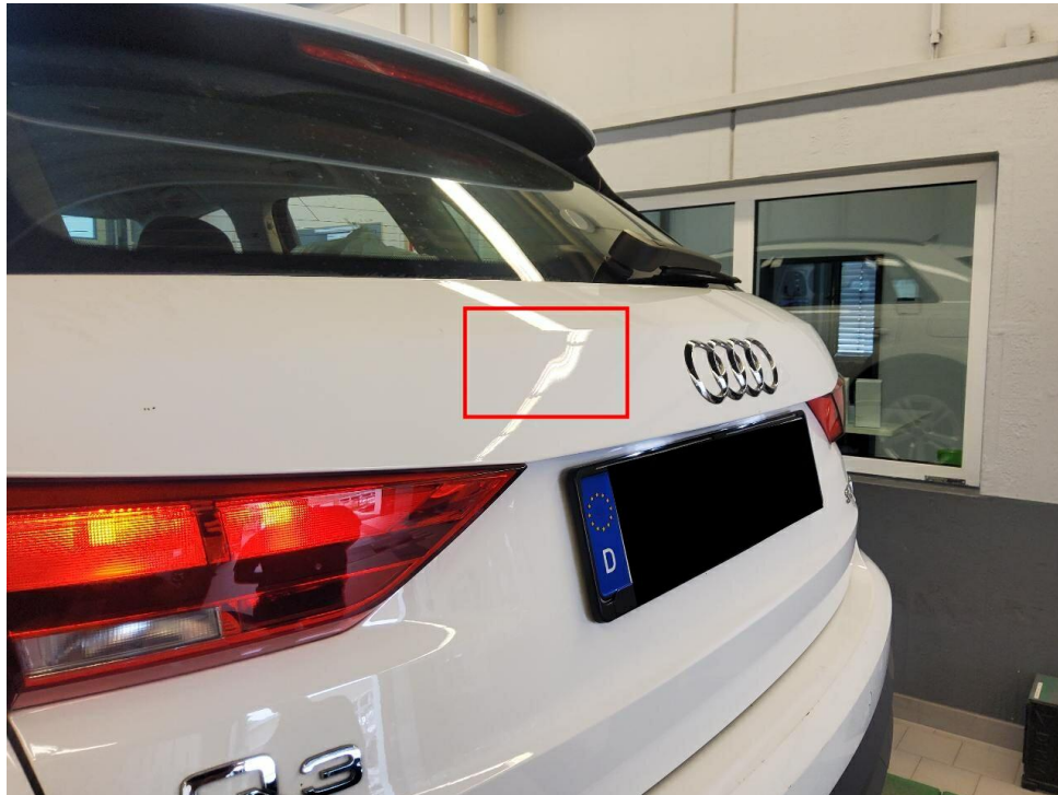
Bild 27 : Heckklappe, mehrfach eingedellt, instandsetzen und lackieren mit Lackaufbau
