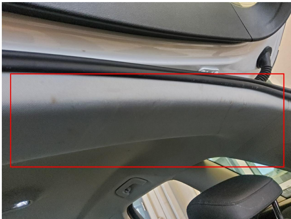
Bild 20 : Dachverkleidung, verschürft, fleckig, eingeschnitten
