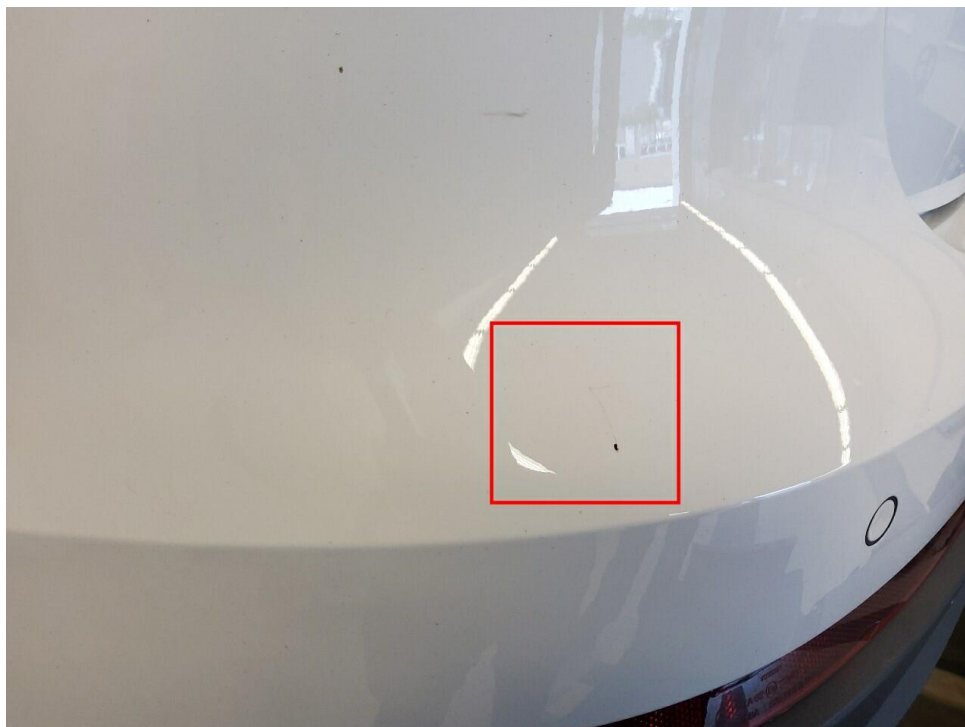
Bild 30 : Stoßfänger hinten Lackierung, zerkratzt, lackieren mit Lackaufbau
