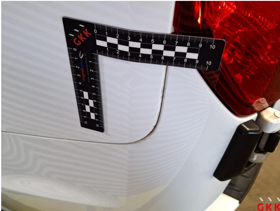
Bild 15 Seitenwand links, beschädigt, kalt drücken
