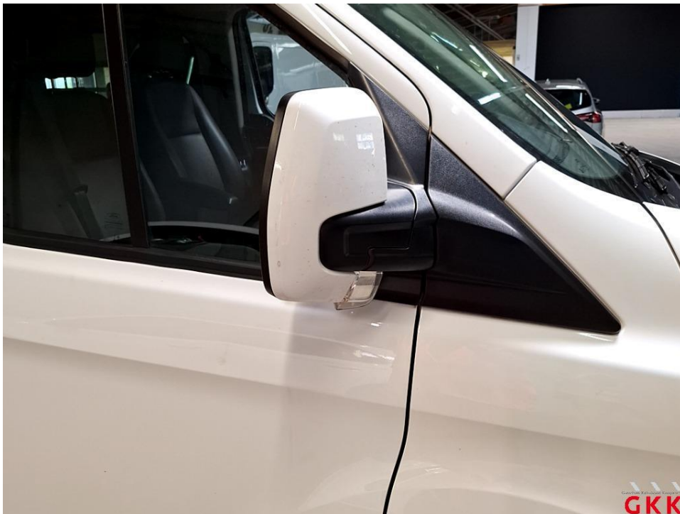
Bild 18 Spiegelgehäuse rechts, Blende -lackiert-, verkratzt, lackieren ohne LV
