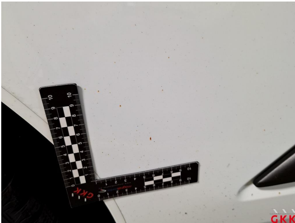
Bild 16 Fahrzeug, außen, Industriestaubhaftung / Flugrost, aufbereiten
