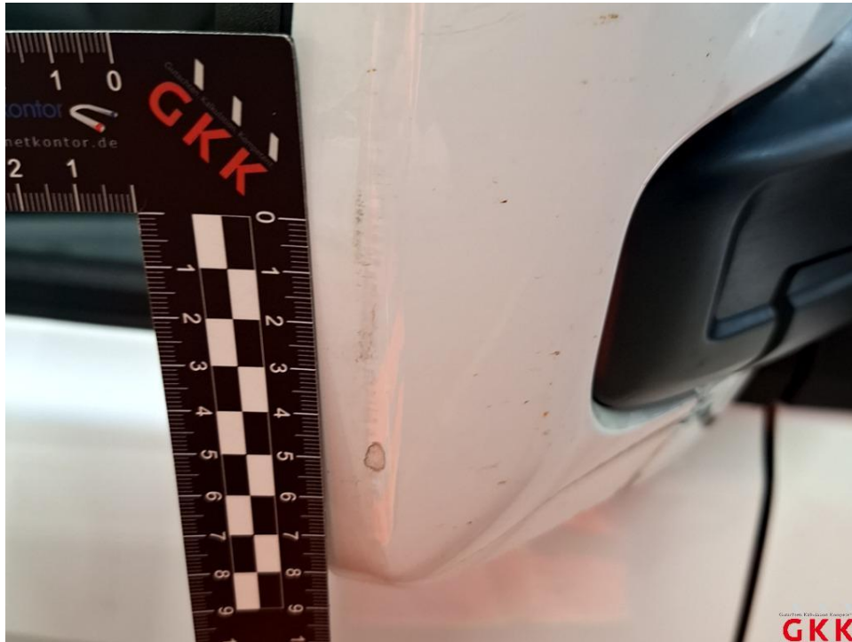
Bild 19 Spiegelgehäuse rechts, Blende -lackiert-, verkratzt, lackieren ohne LV
