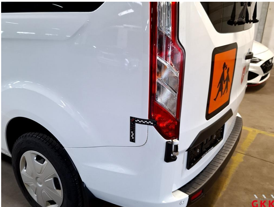
Bild 14 Seitenwand links, beschädigt, kalt drücken
