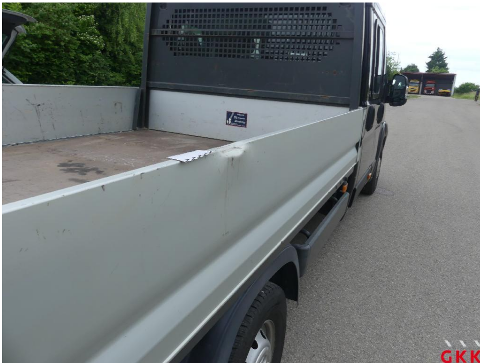
Bild 52 Bordwand, rechts, beschädigt, ersetzen
