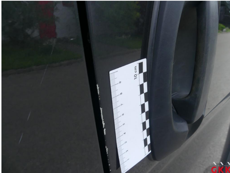
Bild 41 Tür vorne rechts, verkratzt, lackieren
