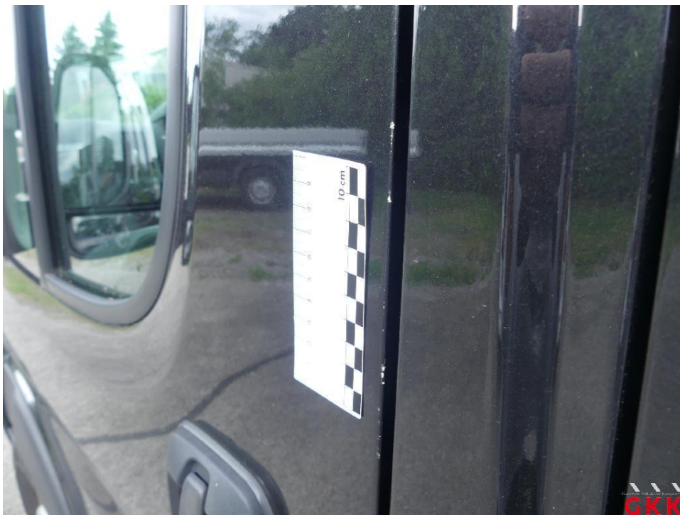
Bild 30 Tür vorne links, Kante, verkratzt, Spotlackieren
