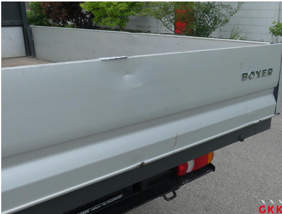
Bild 54 Bordwand, hinten, beschädigt, ersetzen
