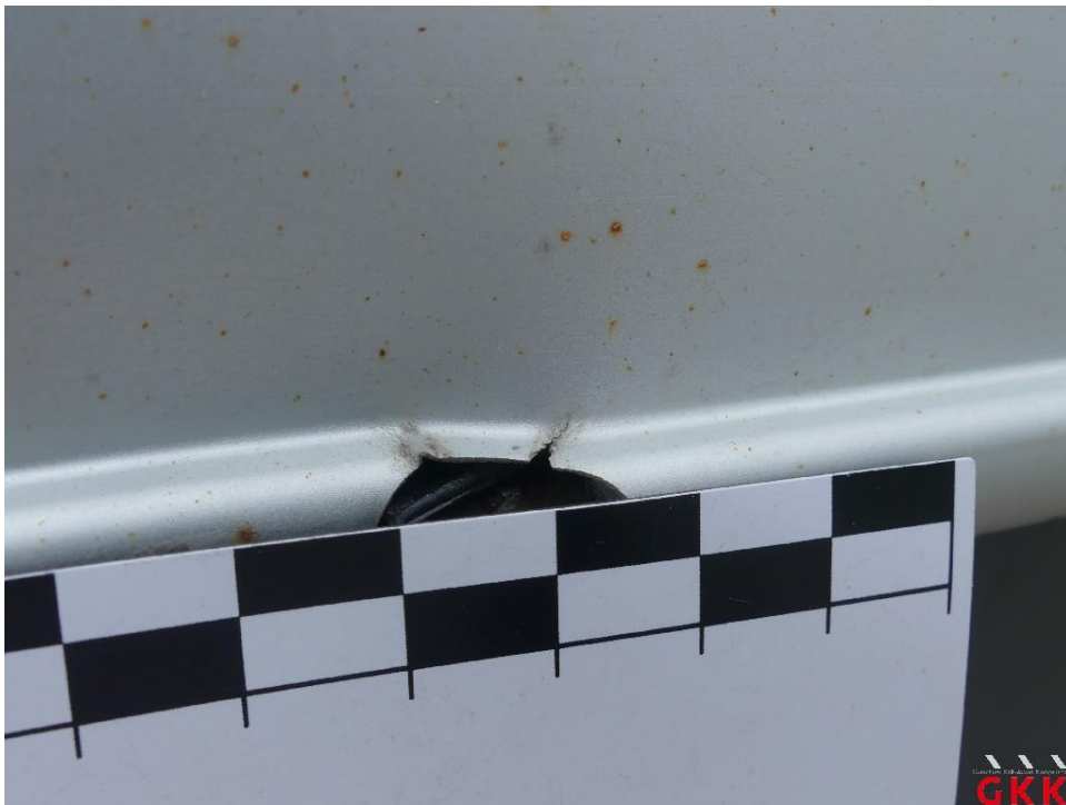
Bild 56 Bordwand, hinten, beschädigt, ersetzen
