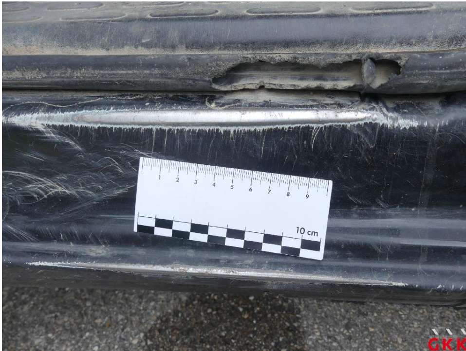
Bild 73 Tür vorne links, Einstieg, verkratzt, Spotlackieren
