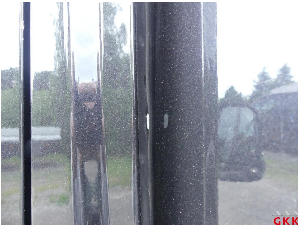
Bild 66 B- Säule links, verkratzt, lackieren
