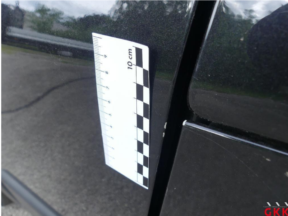
Bild 29 Tür vorne links, Kante, verkratzt, Spotlackieren
