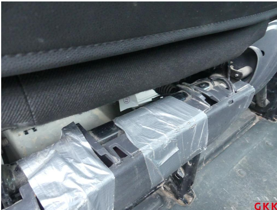
Bild 68 Sitz vorne links, Verkleidung, beschädigt, ersetzen
