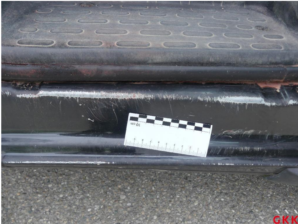
Bild 77 Tür vorne rechts, Einstieg, verkratzt, Spotlackieren
