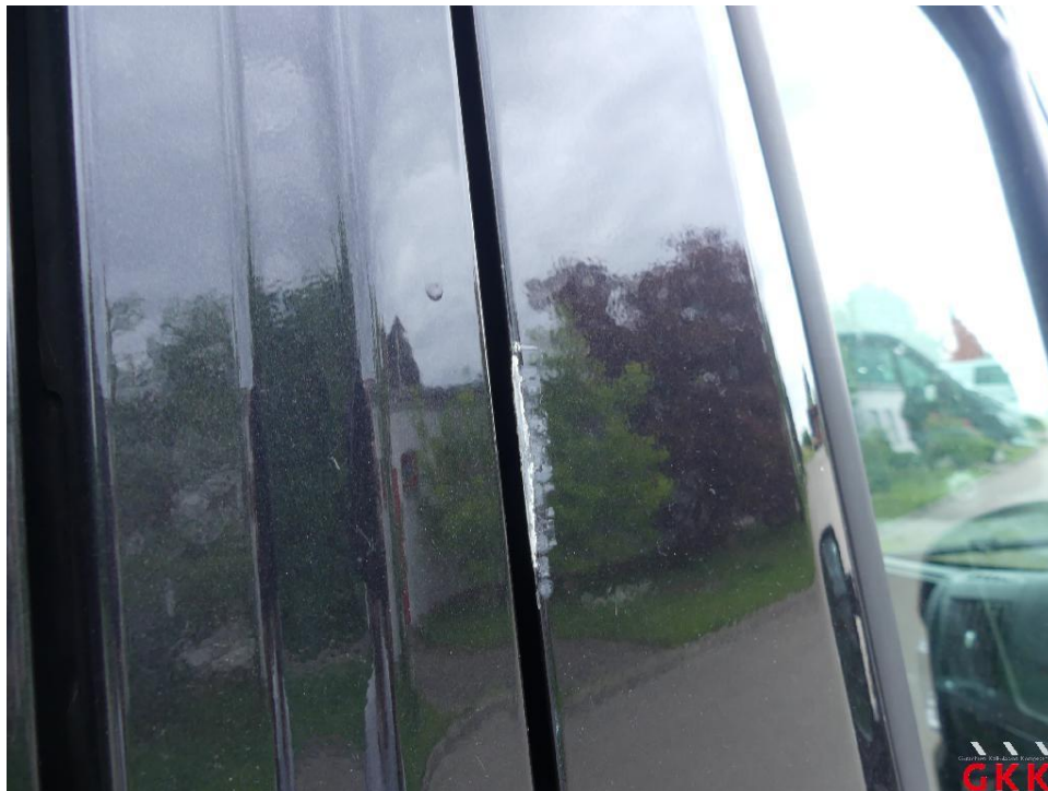
Bild 42 Tür vorne rechts, verkratzt, lackieren
