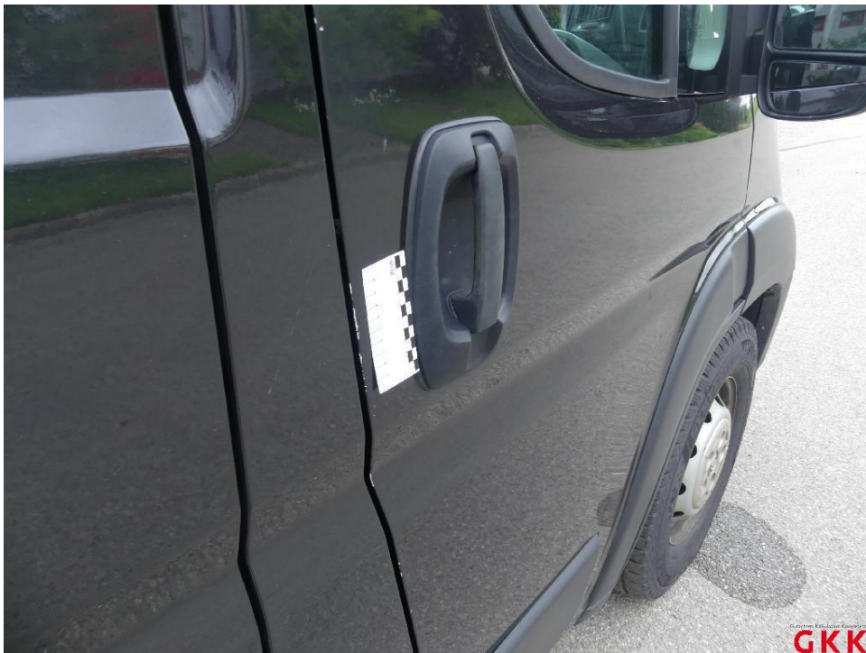
Bild 40 Tür vorne rechts, verkratzt, lackieren
