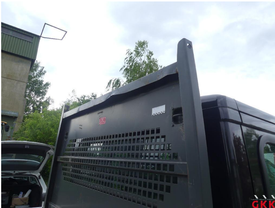
Bild 46 Trenngitter, beschädigt, instand setzen
