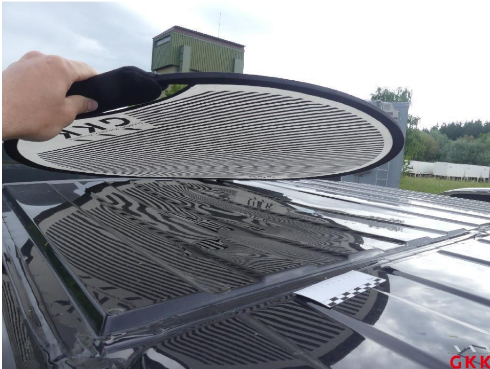
Bild 25 Dach, beschädigt, instand setzen - lackieren
