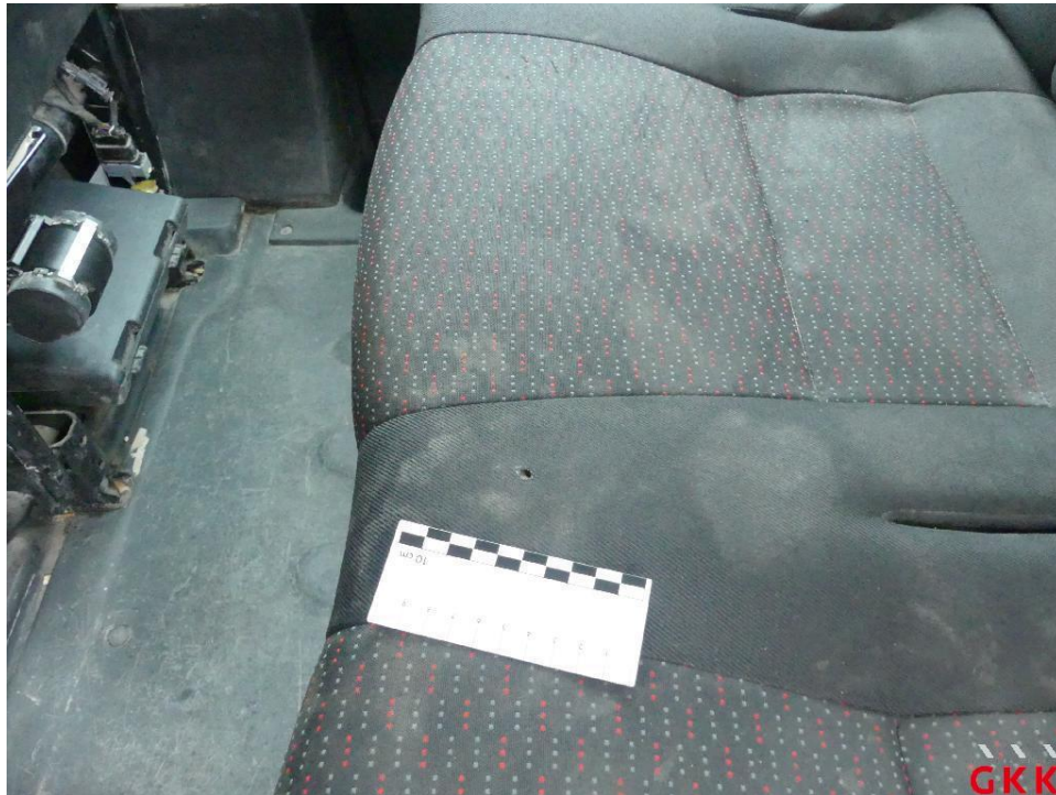
Bild 69 Sitzbank hinten, Bezug Sitzkissen -Stoff-, Brandloch, Smartrepair
