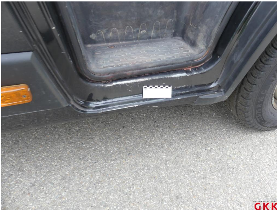
Bild 76 Tür vorne rechts, Einstieg, verkratzt, Spotlackieren
