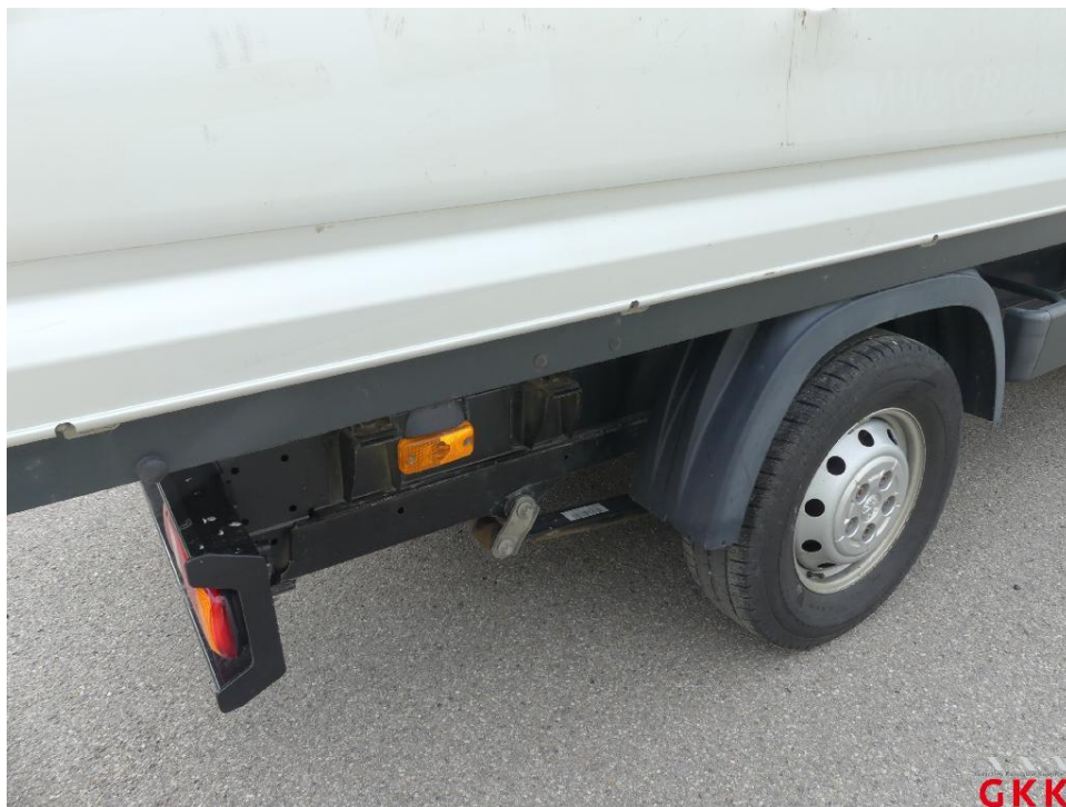
Bild 22 Begrenzungsleuchte hinten rechts, funktionsuntüchtig, ersetzen
