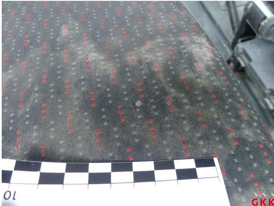
Bild 71 Sitzbank hinten, Bezug Sitzkissen -Stoff-, Brandloch, Smartrepair
