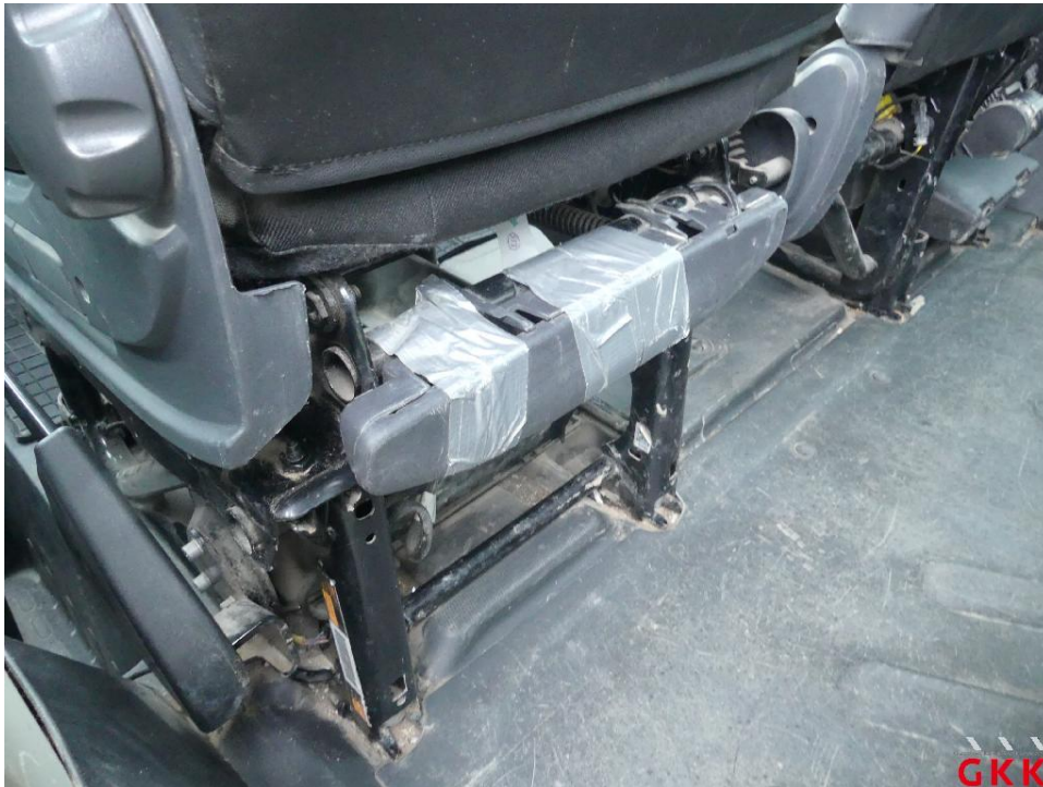
Bild 67 Sitz vorne links, Verkleidung, beschädigt, ersetzen
