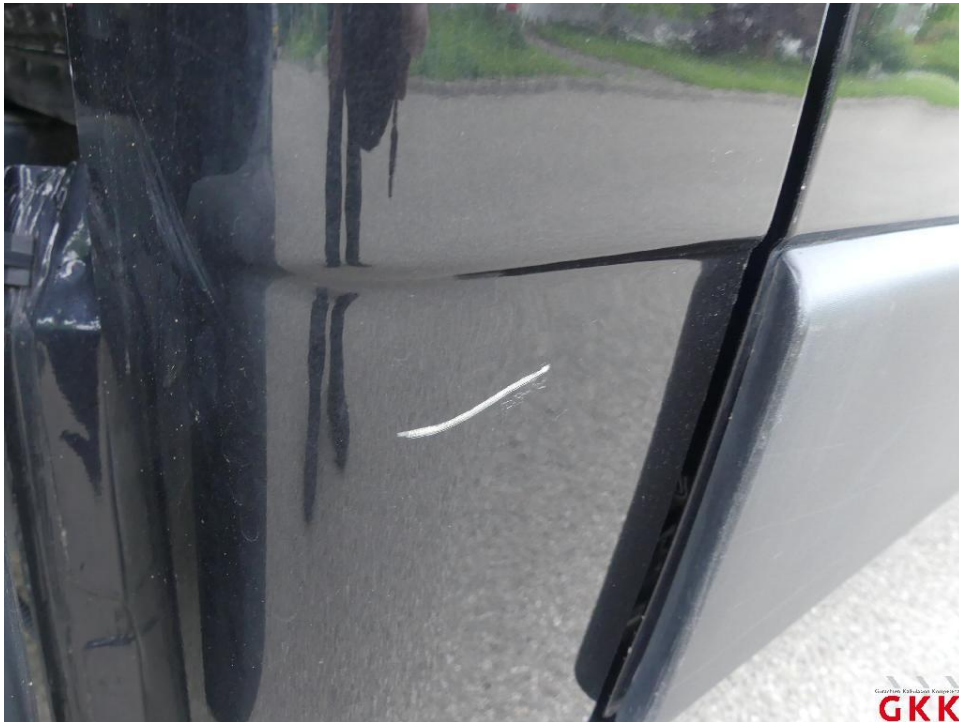
Bild 45 C- Säule rechts, verkratzt, lackieren
