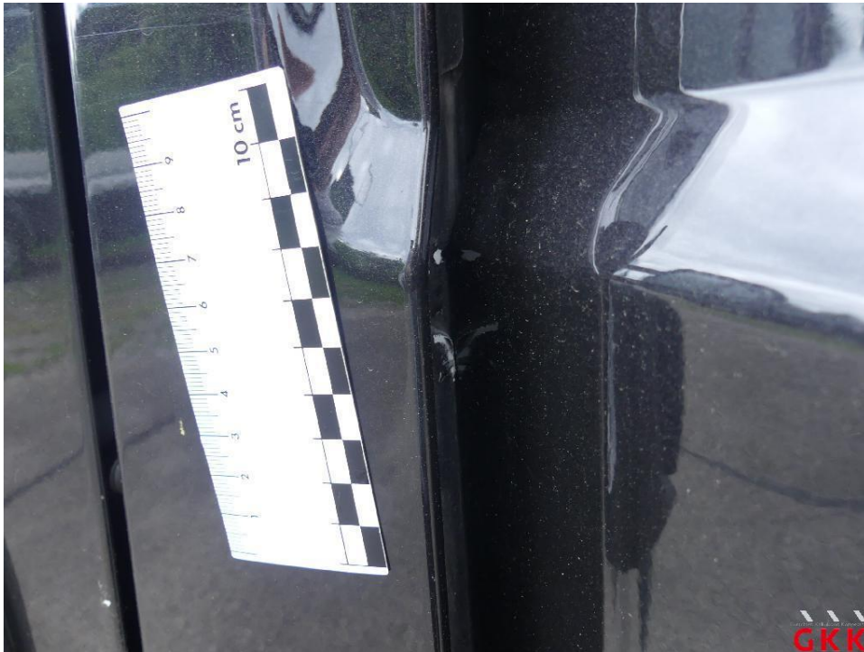
Bild 65 B- Säule links, verkratzt, lackieren
