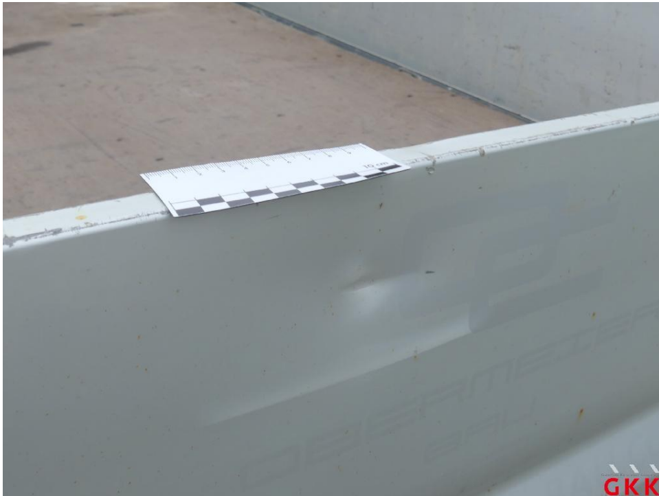
Bild 55 Bordwand, hinten, beschädigt, ersetzen
