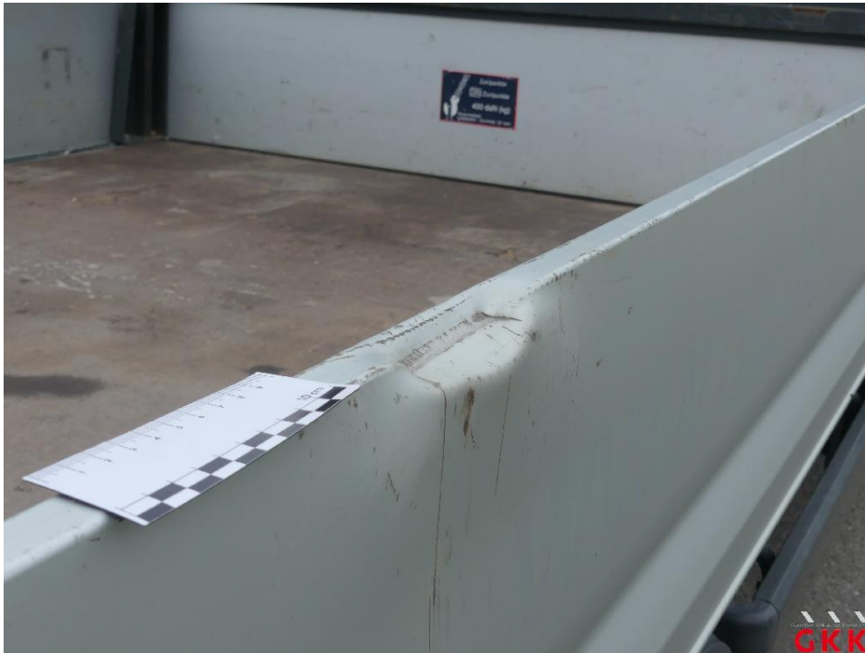
Bild 53 Bordwand, rechts, beschädigt, ersetzen
