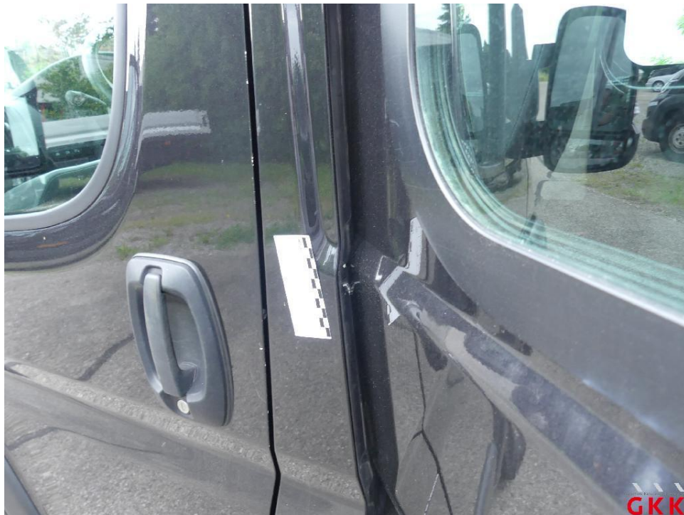
Bild 64 B- Säule links, verkratzt, lackieren
