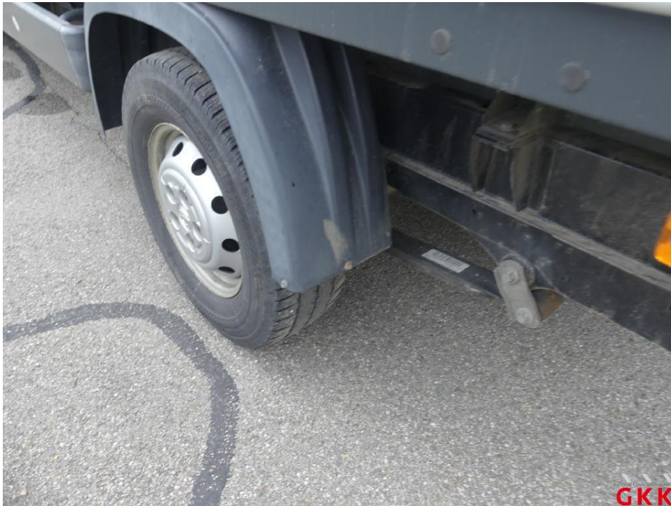
Bild 57 Kotflügel hinten links, Schmutzfänger, fehlt, ersetzen
