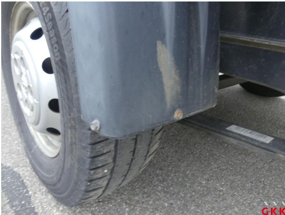
Bild 58 Kotflügel hinten links, Schmutzfänger, fehlt, ersetzen
