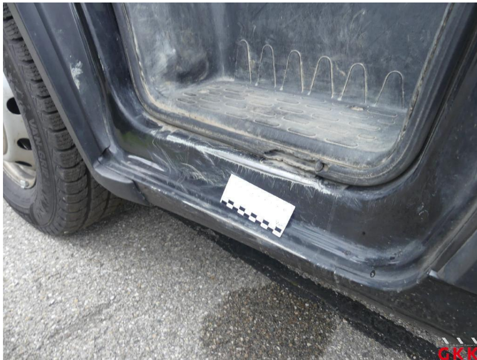
Bild 72 Tür vorne links, Einstieg, verkratzt, Spotlackieren
