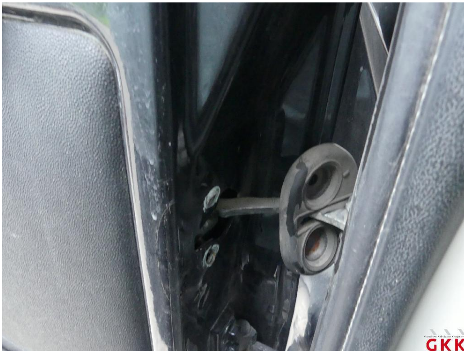
Bild 62 Tür hinten links, Fangband / Feststeller, beschädigt, ersetzen
