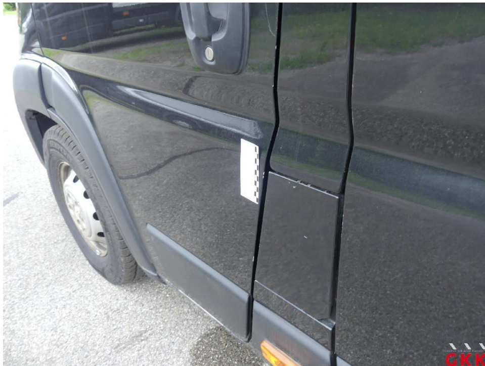
Bild 28 Tür vorne links, Kante, verkratzt, Spotlackieren
