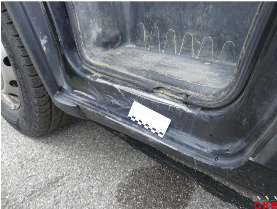
Bild 74 Tür vorne links, Dichtung -Einstieg-, gerissen, ersetzen
