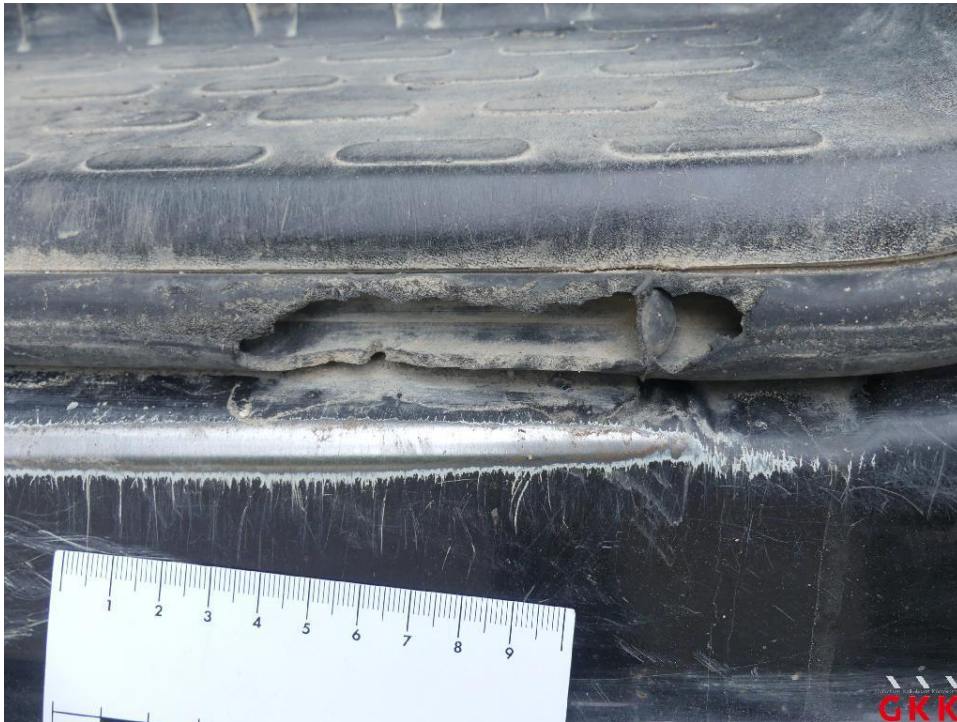
Bild 75 Tür vorne links, Dichtung -Einstieg-, gerissen, ersetzen
