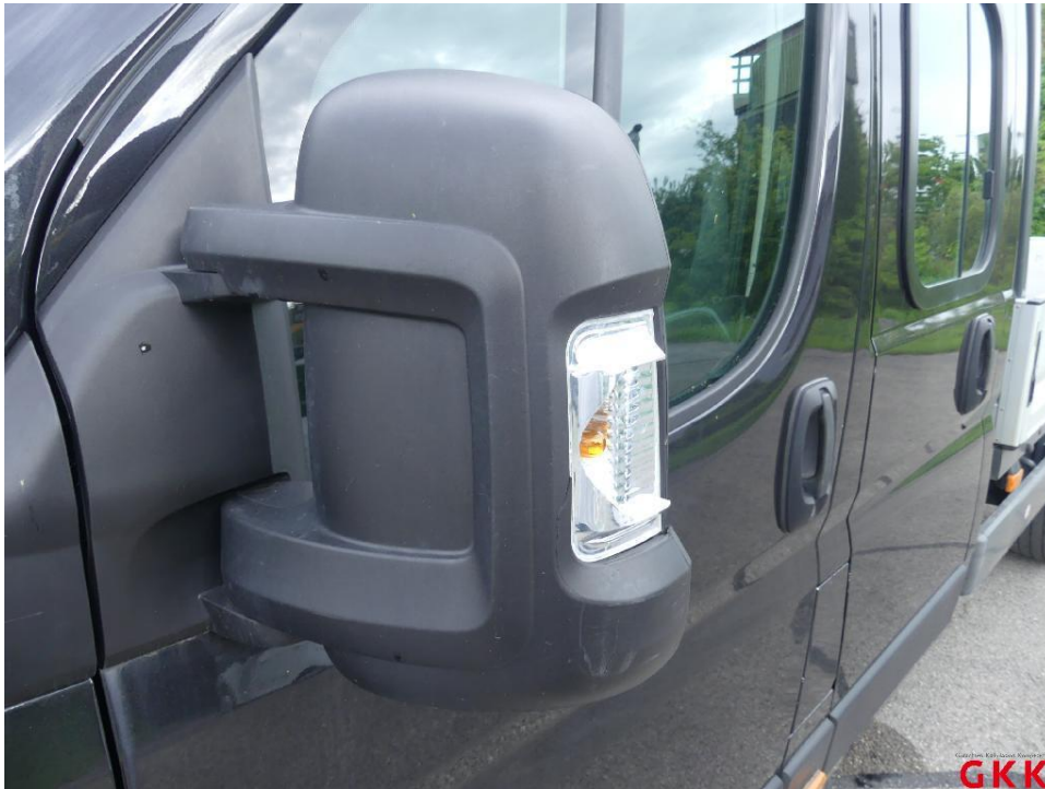
Bild 31 Spiegelgehäuse links, Blende -unlackiert-, beschädigt, ersetzen
