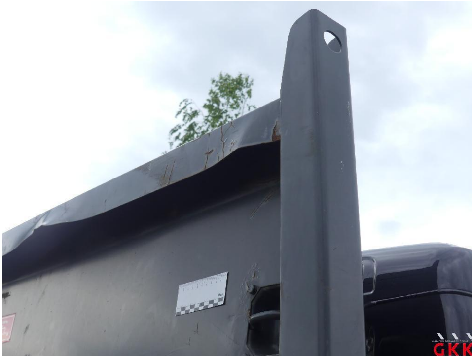
Bild 47 Trenngitter, beschädigt, instand setzen
