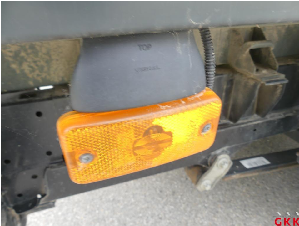
Bild 23 Begrenzungsleuchte hinten rechts, funktionsuntüchtig, ersetzen
