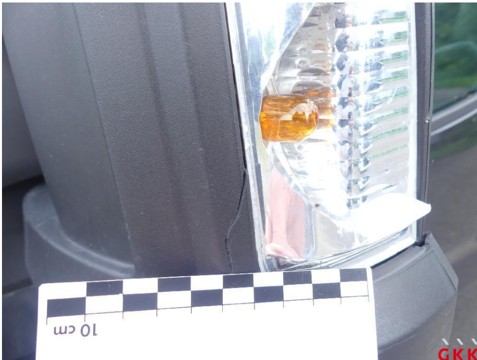
Bild 32 Spiegelgehäuse links, Blende -unlackiert-, beschädigt, ersetzen
