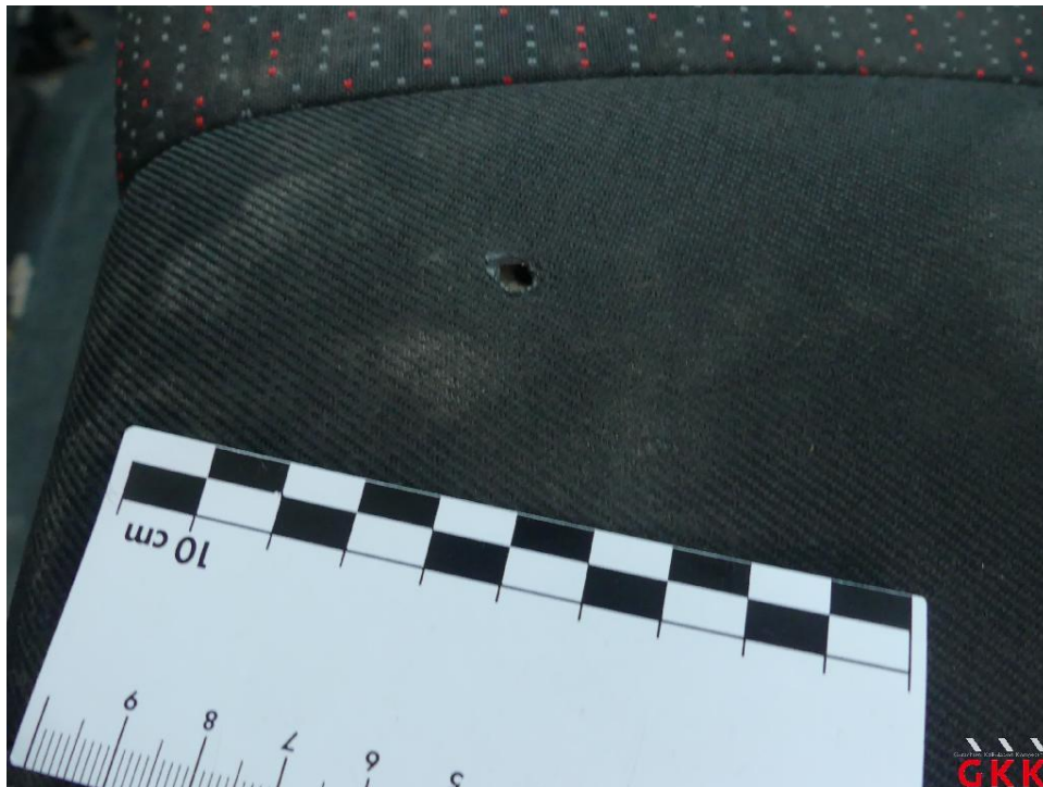
Bild 70 Sitzbank hinten, Bezug Sitzkissen -Stoff-, Brandloch, Smartrepair
